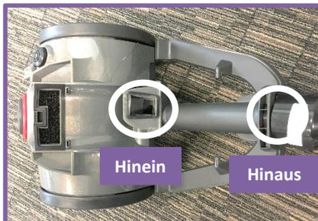
Entnehmen Sie den Staubbehälter, und lassen Sie eine kleine Papierkugel in den Schlaucheingang fallen. Wenn keine Verstopfung vorliegt, fällt die Papierkugel am anderen Schlauchende heraus.
